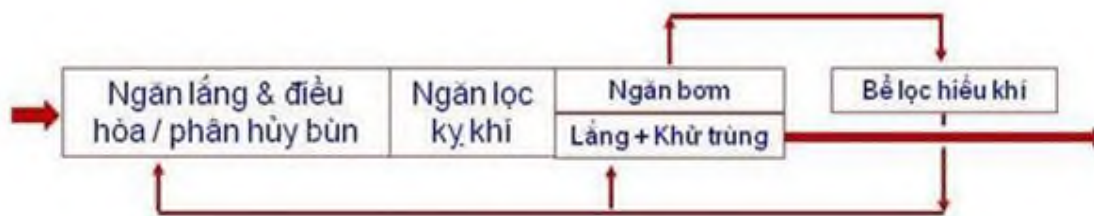
Hình 3.2: Sơ đồ nguyên lý hoạt động của bể Bastafat
